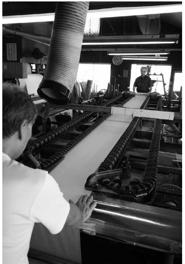
干した反物を巻くための「テンター」という機械。
