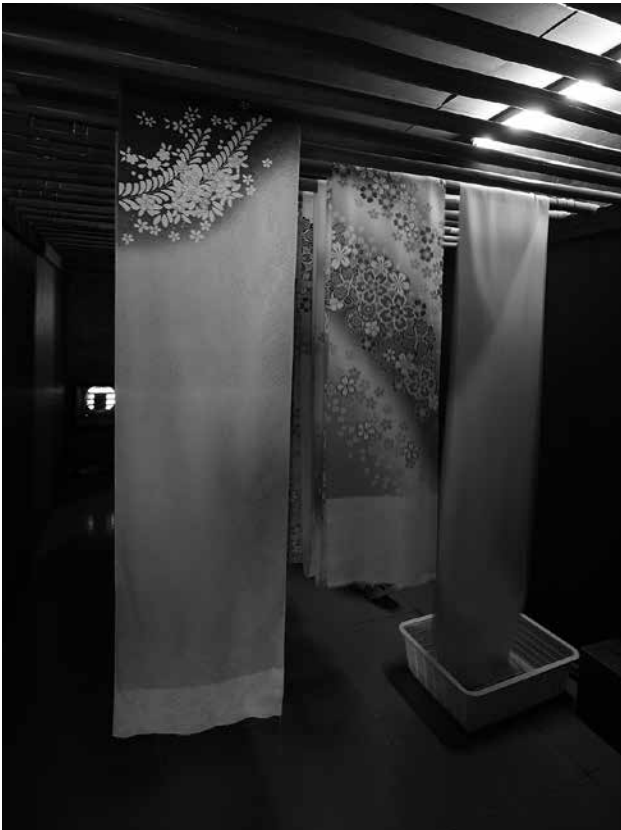
上／蒸した後水洗いを経て、糊を落として色を留める。 下／水洗いした反物を約50度の熱風で乾燥させる部屋。
